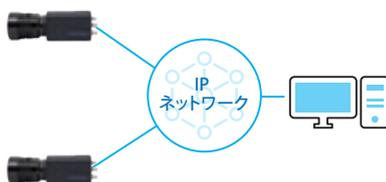
情報カメラなど、光カメラケーブルのない離れた場所に設置したカメラについて、IPネットワークを介して、パソコンから制御が可能です。
