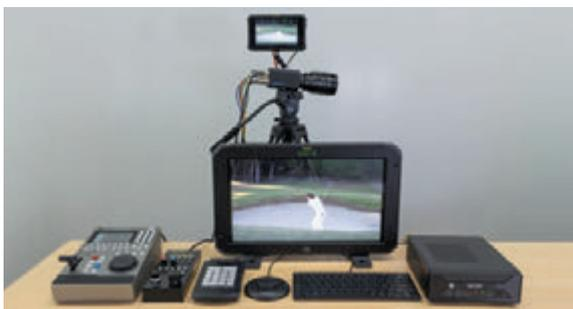
録画中は、ライブ表示、遅延表示が可能です。様々な表示設定が出来ます。録画時間、録画中の遅延表示時間録画停止時の動作、エンコード後ファイルの転送先、静止画の設定、メモリ分割使用設定、ライブ表示、スロー再生時にそれぞれ静止画重ね合わせや線を引くなどオーバーレイ表示に対応しています。
